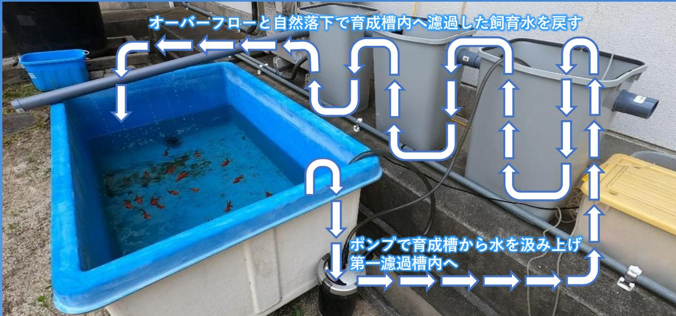
各濾過槽の底までパイプを通して水を落とすことで、濾材を通ってきた上澄みをオーバーフローの要領で次の濾過槽へ送ることができる。
